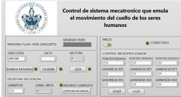
Figura 3. Interfaz gráfica de control, la cual se encarga de programar el micro controlador, enviar los parámetros deseados y adquirir los datos calculados.
