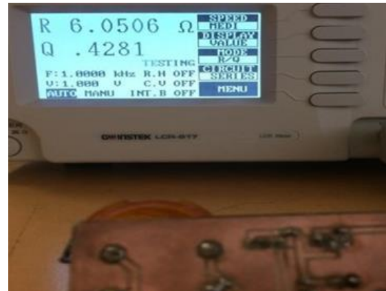
Figura 6. Medición de la resistencia de la bobina secundaria.
