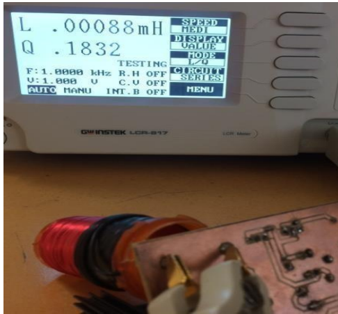
Figura 4. Medición de la inductancia de la bobina primaria.
