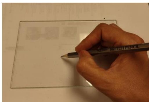
Figura 10. Medición dureza bajo norma ASTM D3363.
