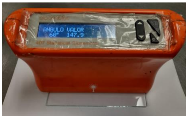
Figura 9. Medición de brillo en placa de vidrio.
