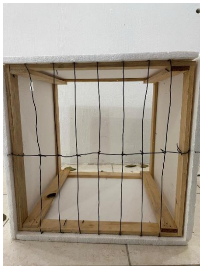
Figura 6. Estructura de alambre recocido N° 18, colocada a uno de los módulos para la fijación de la vegetación.
