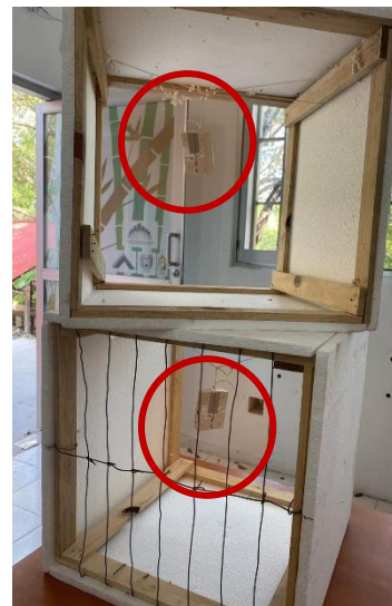
Figura 7. Sensores de temperatura colocados en el interior de cada módulo.
