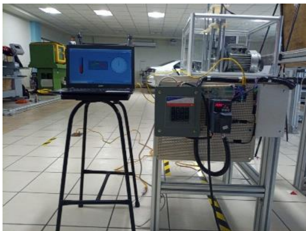
Figura 14. Máquina de desgaste pin on ring desarrollada. Fuente: Elaboración propia.
