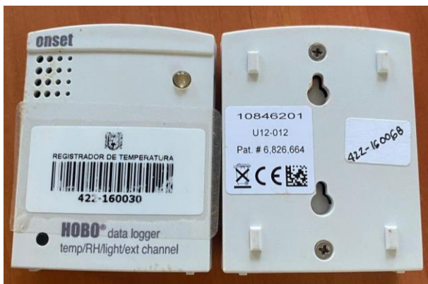
Figura 9. Registrador de Datos (Data Logger) de uso Interior para Temperatura, Humedad Relativa, Luz y un canal para sensores Externos.
