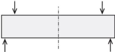
**Figura 2.** Ejemplo de una probeta a flexión. La línea punteada marca la sección de interés para generar la tabla de búsqueda.
