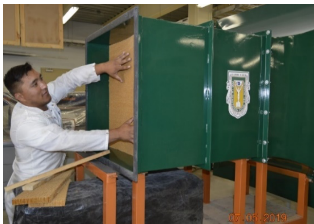
Figura 6. Instalación de honeycomb en cámara estabilizadora
