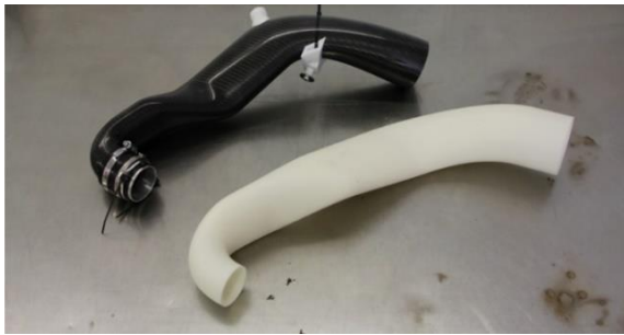
Figura 6. Proceso fabricación con materiales compuestos y núcleos solubles [71].
