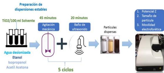
Figura 2. Preparación de dispersiones estables de TiO<sub>2</sub>.
