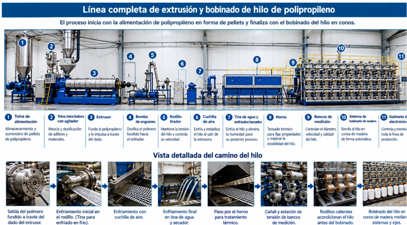
Figura 1. Línea de producción de hilo de polipropileno mediante extrusión y bobinado.
