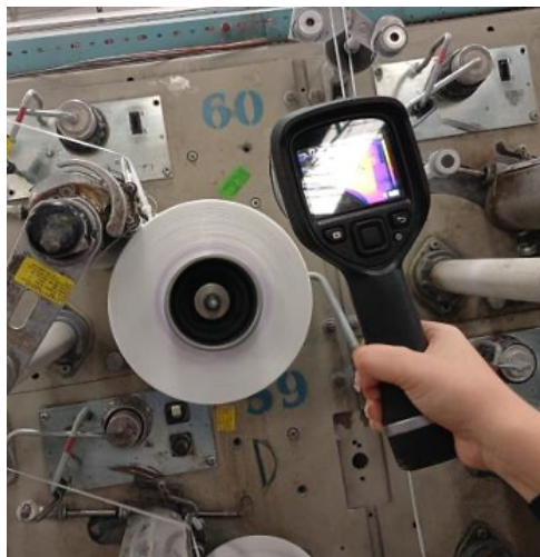
Figura 4. Inspección termográfica realizada a las unidades de bobinado de extrusión para identificar anomalías térmicas.
