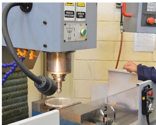
Figura 7. Maquinado de disco soporte.
