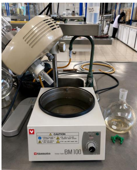
Figura 2. Equipo para purificación mediante evaporación rotatoria de precursores, Yamato BM100.
