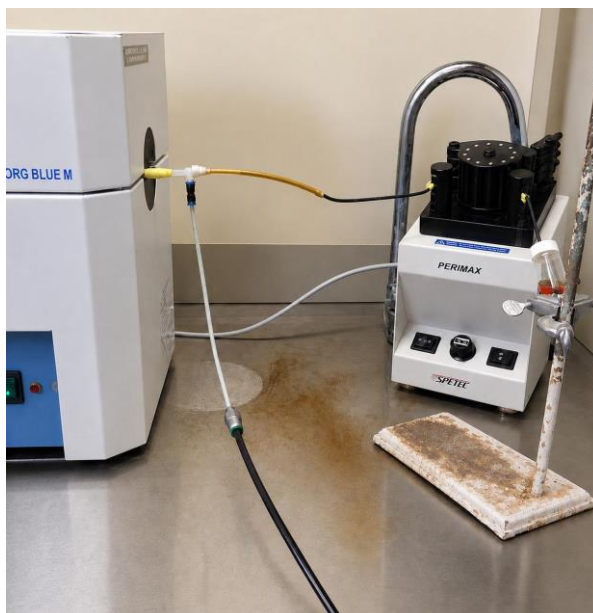
Figura 5. Entrada de solución precursora al reactor (tubo de cuarzo) para síntesis de MWCNT por nebulización pirolítica modificada.
