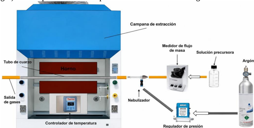
Figura 3. Sistema de síntesis para obtención de MWCNT por nebulización pirolítica modificada.
