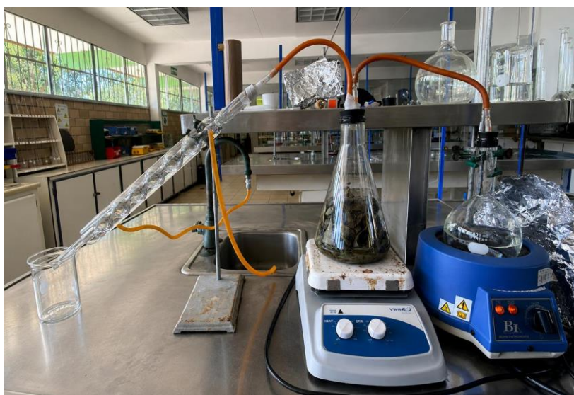
Figura 1. Sistema de destilación para extracción de precursores.
