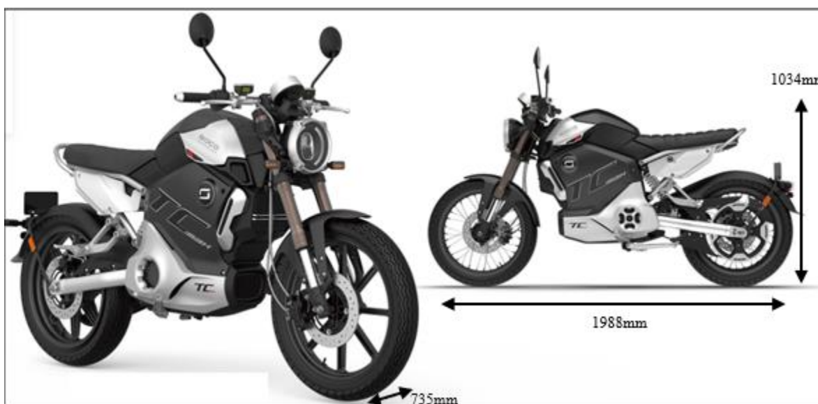
Figura 5. Motocicleta “TC Max Super Soco 2023” y sus dimensiones (SUPER SOCO, 2024).
