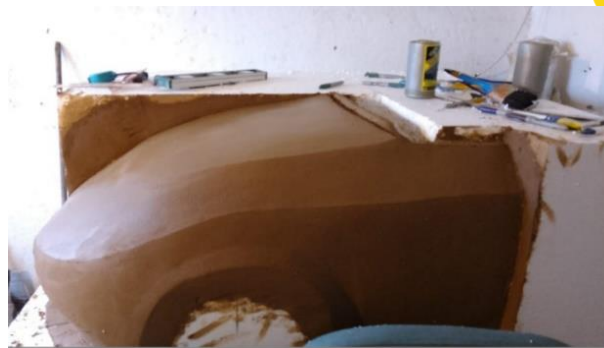
Figura 8. Modelo de barro sobre base de unicel.
