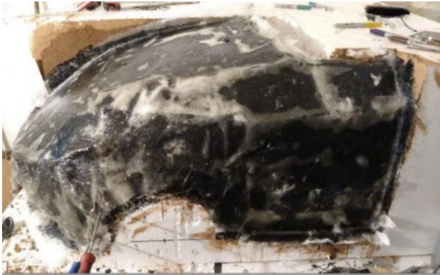
Figura 9. Aplicación de fibra de vidrio y resina para obtener parte del negativo.
