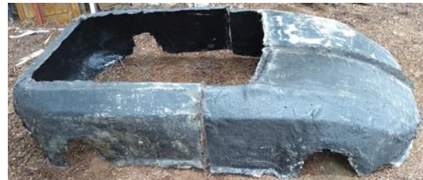
Figura 12. Negativo para segundo prototipo de carrocería.
