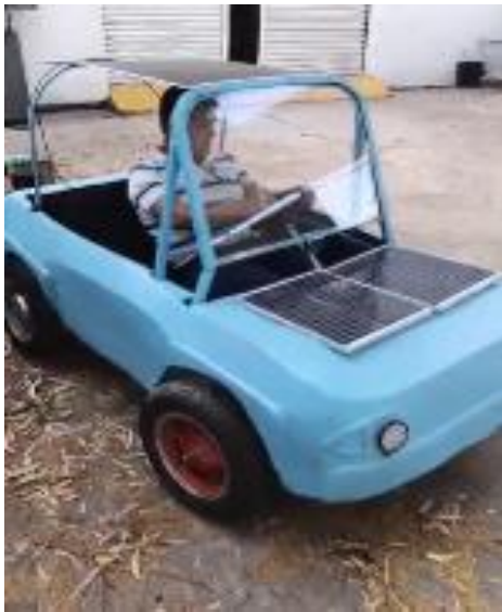
Figura 13. Primer prototipo de carrocería con paneles solares en toldo y capó.
