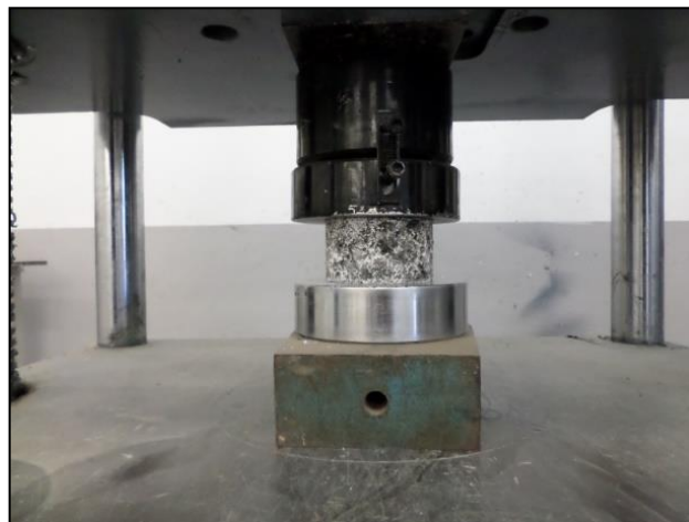
Figura 3. Muestra en prensa Universal de compresión simple.
