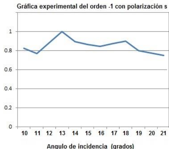
Figura 5. Gráfica de los valores de la intensidad del orden -1 para una señal de luz con polarización (TE). Como se muestra en la gráfica, la intensidad de luz no tiene una caída en su valor alrededor de los 16.75^{\circ} . Los datos de lectura tomados con un fotodetector están normalizados.
