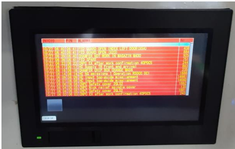
Figura 14. Pantalla de interfaz con el usuario instalada en línea de producción.
