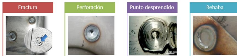
Figura 2. Principales defectos en la soldadura por RSW.
