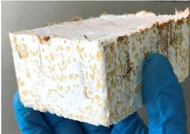
**Figura 8.** Prototipo de biotabique 2.
